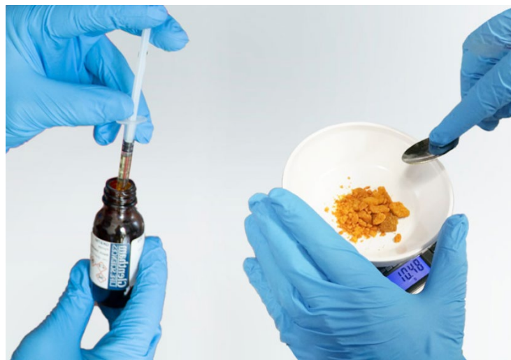
Le pyrrole (à gauche) et le chlorure de fer(III) (à droite), utilisés comme réactifs de polymérisation.
