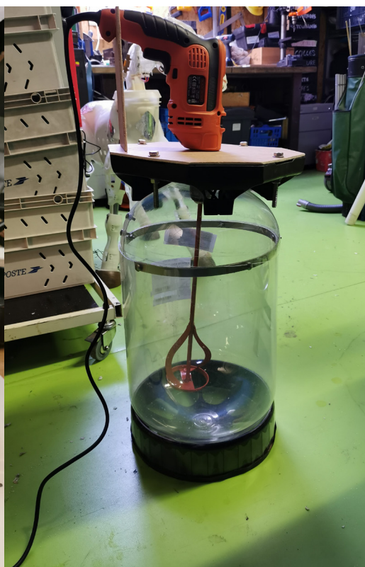
Fig. 3 : Détournement d'outils afin de polymériser de plus grandes pièces de textile.
