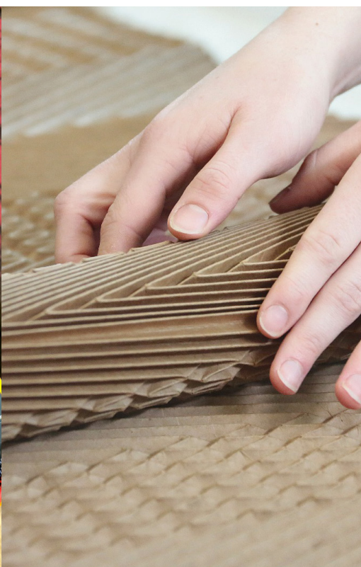
Fig. 5 : le textile est ensuite plissé par la Maison Lognon, en utilisant des moules nommés cartons.
