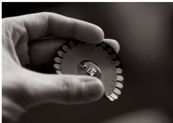
Figure 1. Une carte flexible Lilypad Arduino , créée pour être incorporée dans des technologies wearable par Leah Buckley, directrice de l'équipe de recherche high-low-tech. 2008 © Jean-Baptiste Labrune
