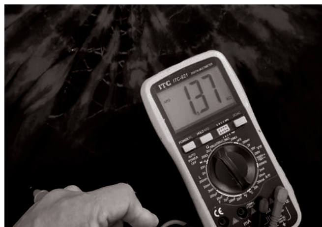
Figure 3. Après avoir subi le procédé chimique, le textile a acquis des propriétés conductrices. 2019 © Martin De Bie
