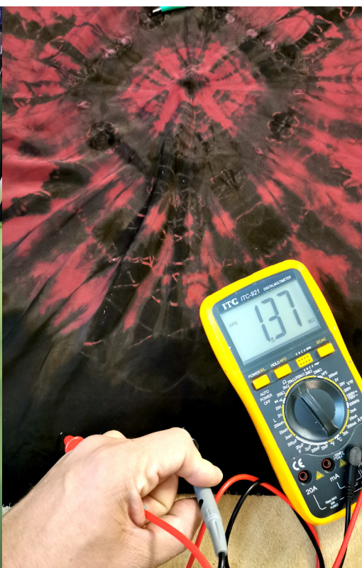
Fig. 4 : résultat d'une polymérisatio conductrice sur un textile en polyester ligaturé.
